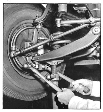
Fig. 3-3—Loosening Lower Ball Stud
