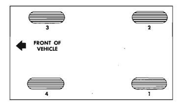
Fig. 5-3-Proper Bleeding Sequence
