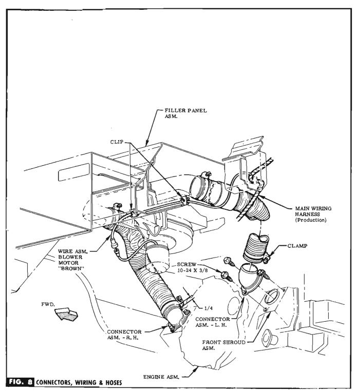
STEP 30 REMOVE COVERS FROM FRONT SHROUD ASM. & DISCARD. RETAIN SCREWS.
