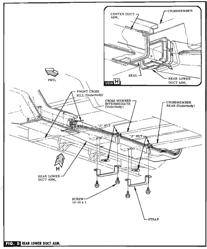
**STEP 25** DISCONNECT RIGHT HAND BRAKE CABLE BEFORE INSTALLING REAR LOWER DUCT.
