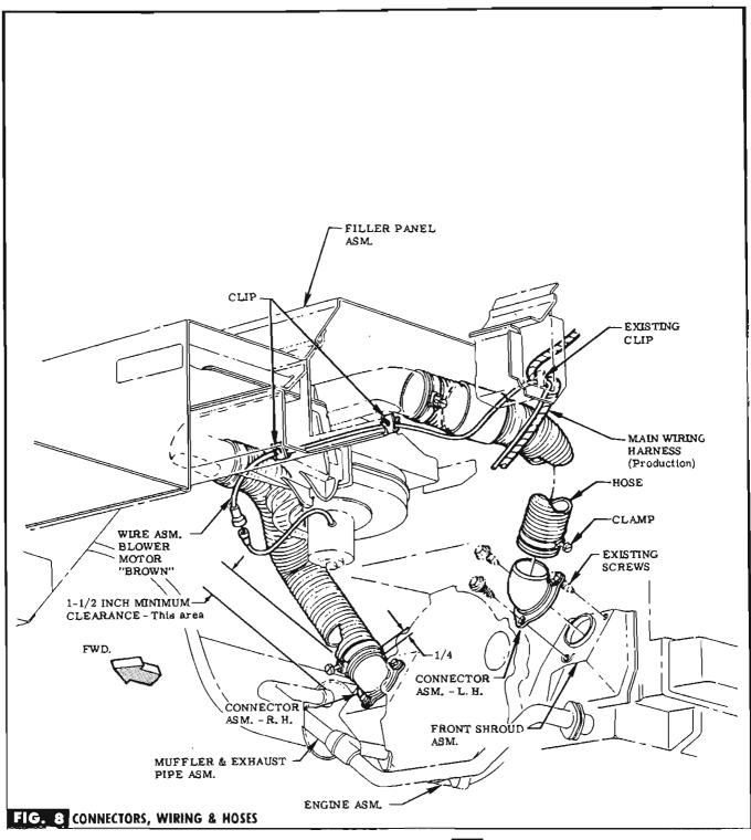
STEP 42 REMOVE COVERS FROM FRONT SHROUD ASM. & DISCARD. RETAIN SCREWS.
