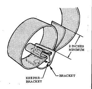
FIG. 11 OPERATION PROCEDURE & BELT ADJUSTMENT
