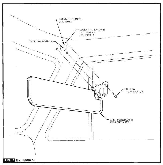
**STEP 1** LOCATE EXISTING DIMPLE & DRILL LARGE HOLE IN TRIM PANEL. SEE FIG. 1.
