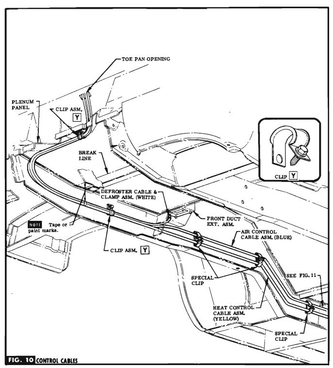
STEP 55 ROUTE DEFROSTER CABLE ALONG RIGHT SIDE RAIL THRU TOE PAN OPENING, GROMMET & TO HEATER CONTROL AS SHOWN IN FIG. 9 & 10. ALIGN TAPE OR PAINT MARKS ON THE CABLES DIRECTLY BELOW FLOOR TO TOE PANEL BREAK LINE BEFORE CLIPPING TO UNDERBODY. ROUTE ALL CABLES ALONG RIGHT SIDE RAIL & ATTACH
